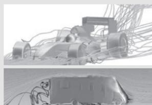
Lors de la conception de la face avant de nos intégraux, l'un des objectifs était d'optimiser le coefficient de pénétration dans l'air ( $C_x$ ) afin de réduire la consommation de carburant et les bruits parasites. Nos ingénieurs se sont naturellement appuyés sur des spécialistes intervenant notamment dans le domaine de la course automobile (Formule 1, 24h du Mans).
